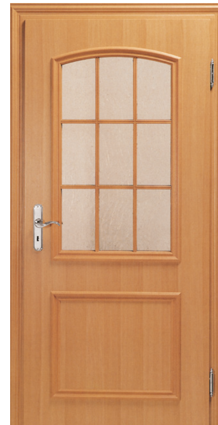
Modell: Wien , Ornamentglas Silvit, Segment- Glashalterahmen mit Sprossen, 9-fach unterteilt, und aufgesetztem Rechteck- rahmen aus Massivholz.
