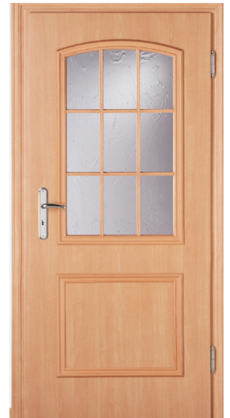
Modell: Wien , Ornamentglas Gotik, Segment-Glashalterahmen mit Sprossen, 9-fach unterteilt, und aufgesetztem Rechteckrahmen aus Massivholz.
